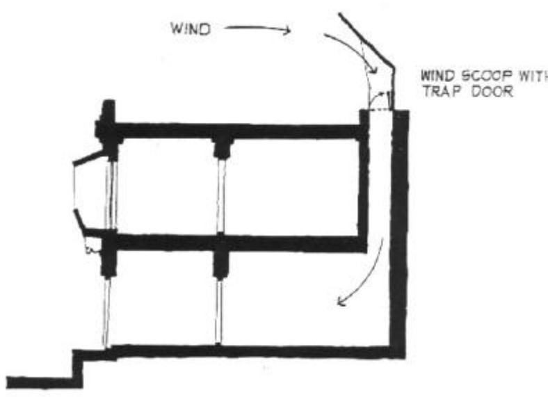
FIG. 25-UNIDIRECTIONAL WIND SCOOP (BUNG.)
