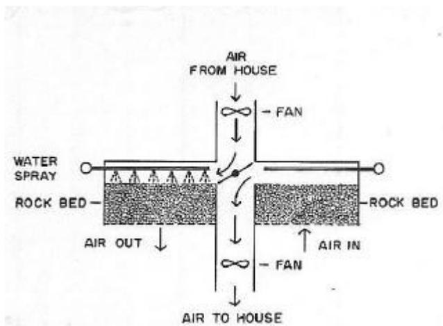
FIG. 18-ROCK-BED REGENERATIVE COOLER
